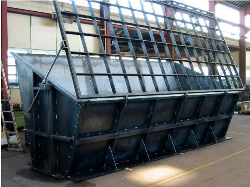
Trichteraufsatz mit Gitteraufsatz,
