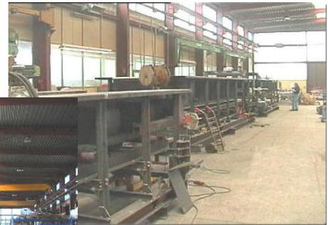
Halle I; ca. 3000 qm, Arbeitshöhe ca. 6 m mit 80 kN und 100 kN - Brückenkranen
