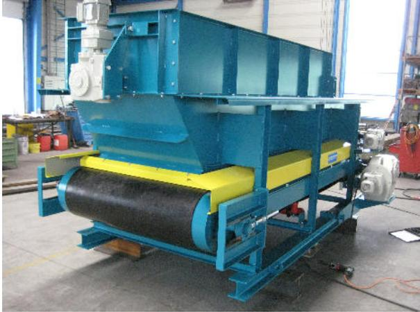
KBGR 1,0/3,5 mit Aufsatztrichter und integrierter Auflockerungshaspel mit Edelstahl-VA-Pratzen
