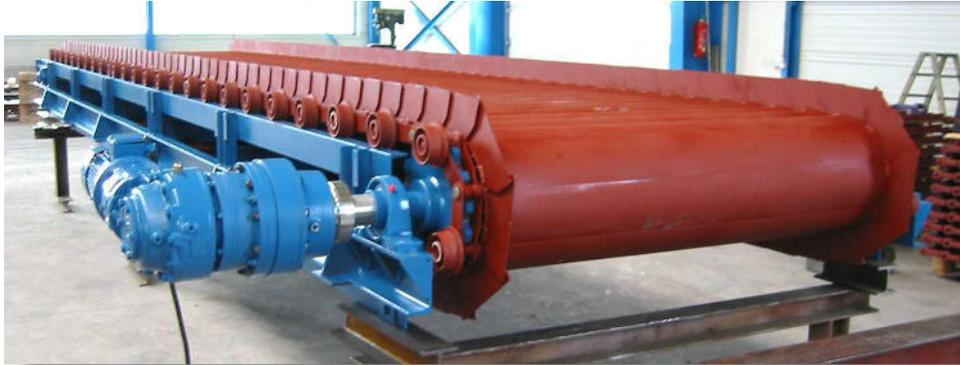
Stahlschuppenband ( BB 1500 mm; AA 8,0 m); mit wälzgelagerten Rollen, Kette mit Schleißbuchsen, Ketten verkleidet. Bändeinsatz: KFZ-Recycling; Shredderleichtfraktion Trichter bauseits 40 cbm Inhalt
