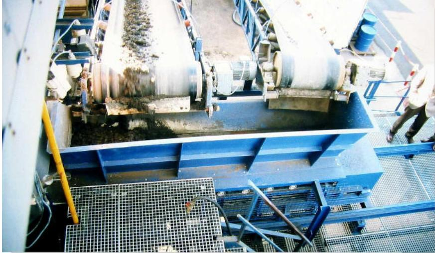
Stahlschuppenband fahrbar mit Trichteraufsatz bei Förderbandbeschickung;
