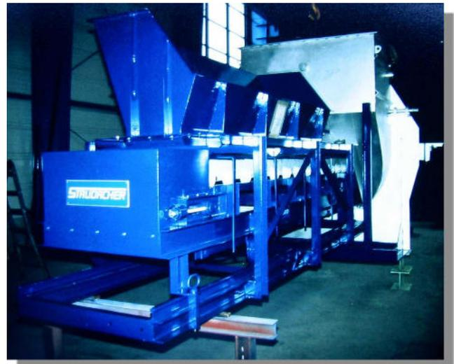
Stahlschuppenband für Drehofenbeschickung mit Ofenanschluss aus VA für kontaminierte Erden
