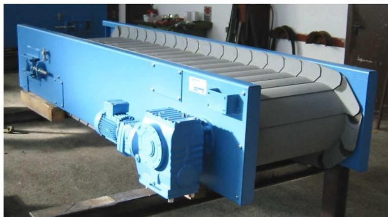
Stahlschuppenband STL mit geschlossenen Seitenwänden ohne Trichteraufsatz
