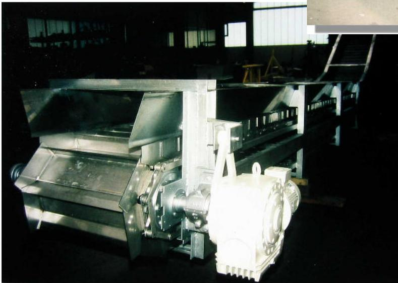
Zellen-Stahlschuppenband nach Drehofenausrag mit Schuppenzellen aus Edelstahl
