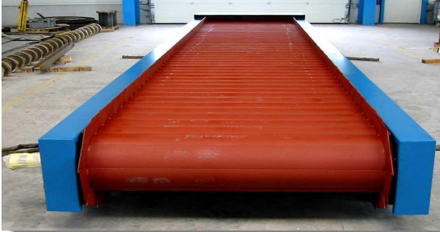
Stahlschuppenband mit geschlossenen Seitenwänden ohne Trichter-aufsatz
