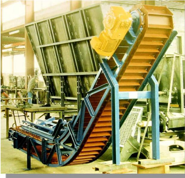
Zellenschuppenband für Steilförderung bei riesel-fähigen Materialien, z.B. Blähton nach Ofen
