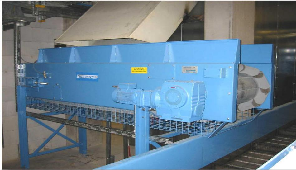
Stahlschuppenband STL mit geschlossenen Seitenwänden und Trichteraufsatz für Transport von Metallspänen und dünnen Schrottblechen beim Kunden im Metallwerk
